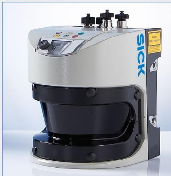
屋外用レーザ測定システム LMS511 は、レーザ・パルスのタイム・オブ・フライト (TOF、光の伝播時間測定) の原理を使用した、距離測定用レーザ・スキャナです。レーザを走査して、最大 190° の範囲の角度ごとの距離を測定することにより、半径最大 80m の周囲の輪郭を捉えて出力します。
