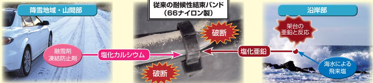
亜鉛めっき鋼製の亜鉛と海水に含まれる塩分が反応すると塩化亜鉛が発生し、短期間で66ナイロン製結束バンドを劣化・破断させます。降雪地帯や山間部で散布される融雪剤・凍結防止剤の主成分である塩化カルシウムも66ナイロン製結束バンドを劣化・破断させる原因です。
